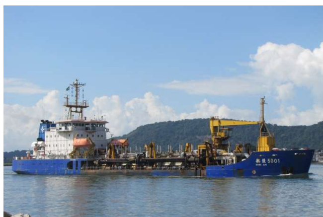
Figura 06: Draga autotransportadora.
